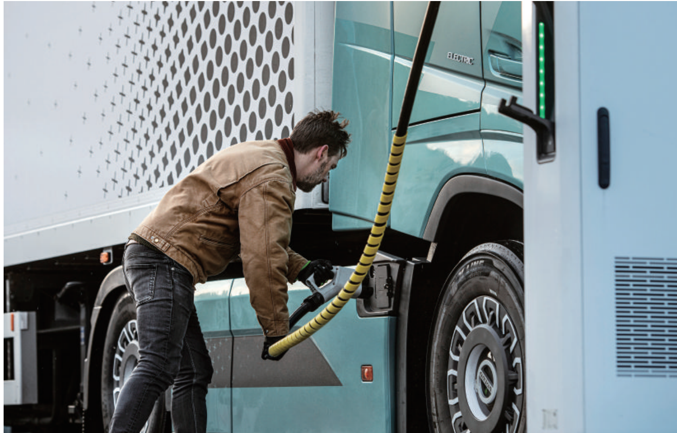
以FH Electric為例，若是在250kW的DC直流快充情境下，僅需2.5小時即可完成100%的能源補充。
